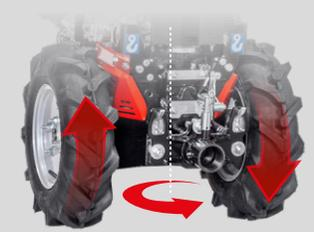
Die Köppl **Turnaround-Aktivlenkung** dreht das Motorgerät direkt über den Mittelpunkt um 180° auf der Stelle. Die Radmotoren werden einzeln gegenläufig angetrieben und sorgen für volle Kontrolle bei der Wende mit minimalem Kraftaufwand und maximaler Schonung des Untergrunds.
